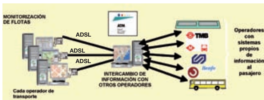
Arquitectura del SAE multiflota de la ATM
